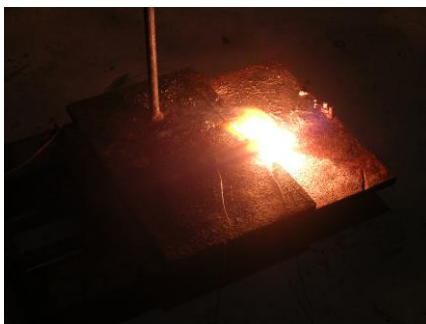
Rajah 4: Pembakaran jalur propelan tanpa bahan penambah
