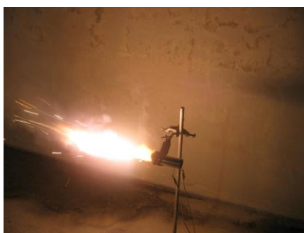
Rajah 5 Pembakaran jalur propelan dengan bahan penambah
